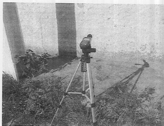
Figura 3. Detalhe do decibelímetro no momento da medição na lateral do estabelecimento.
